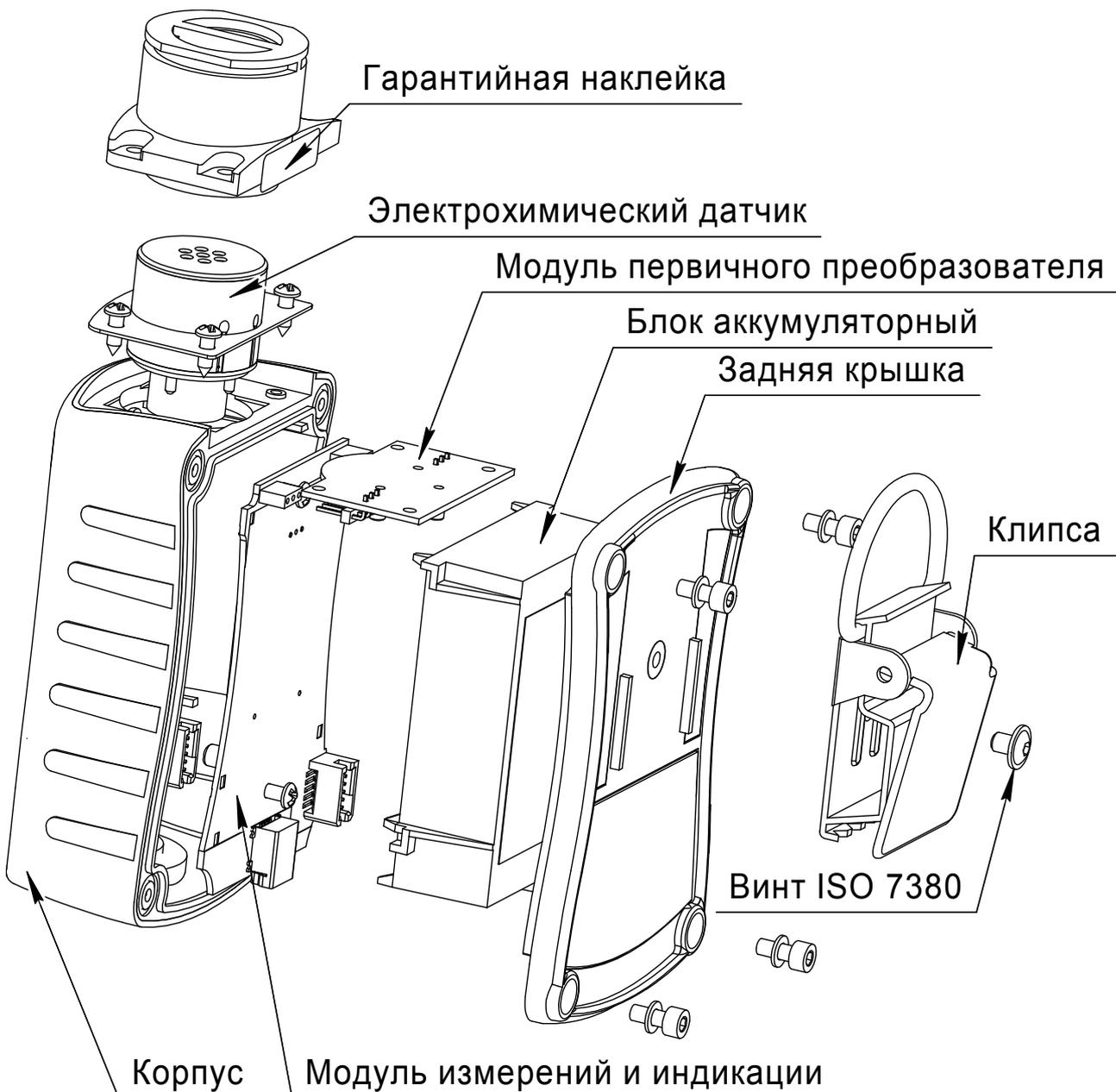
**Рисунок 1.2** – Основные составные части газоанализаторов
