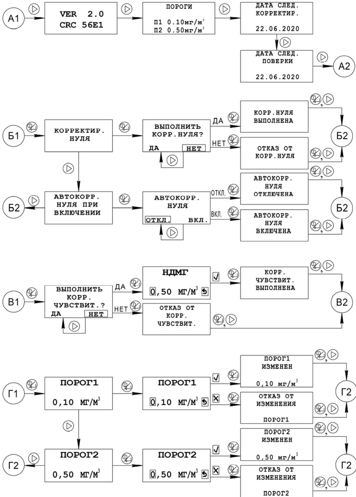
**Рисунок А.2 – Схема режимов работы**
