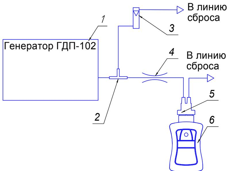
1 – генератор ГДП-102 с установленным источником микропотока  $\text{NO}_2$ ; 2 – тройник; 3 – индикатор расхода; 4 – зажим Гофмана; 5 – колпачок поверочный; 6 – газоанализатор.
