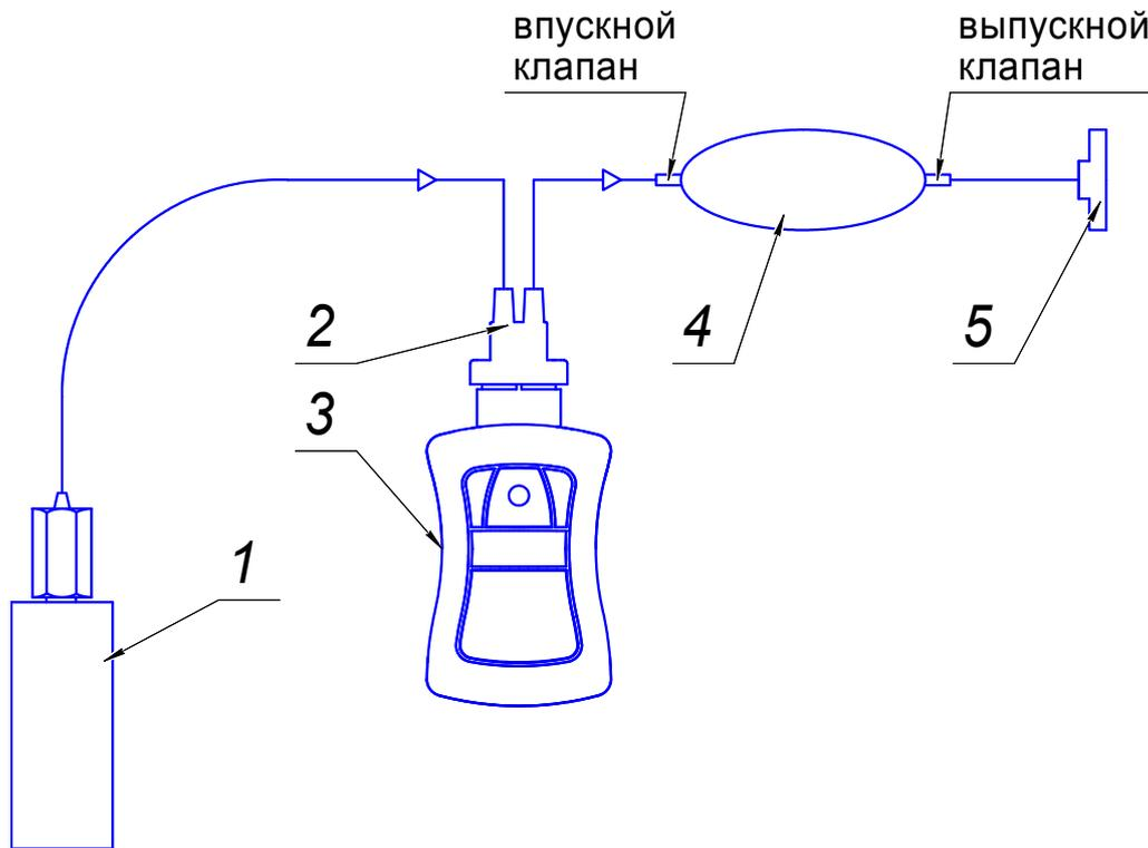
1 – пробозаборник; 2 – колпачок поверочный; 3 – газоанализатор;
