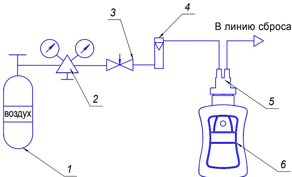
1 – баллон со сжатым воздухом; 2 – редуктор баллонный; 3 – вентиль точной регулировки; 4 – индикатор расхода; 5 – колпачок поверочный; 6 – газоанализатор.
