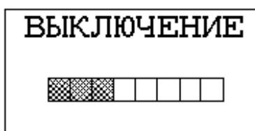
**Рисунок 2.2** – Вид табло при выключении газоанализатора
