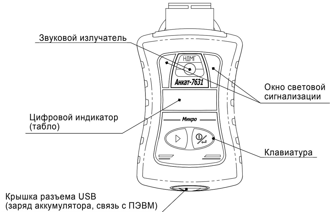
**Рисунок 1.3 – Органы управления и сигнализации газоанализаторов**
