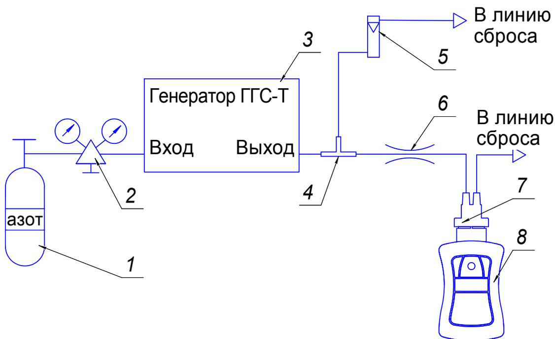
1 – баллон с азотом; 2 – редуктор баллонный; 3 – генератор ГГС-Т с установленным источником микропотока (НДМГ или  $N_2H_4$ ); 4 – тройник; 5 – индикатор расхода; 6 – зажим Гофмана; 7 – колпачок поверочный; 8 – газоанализатор.
